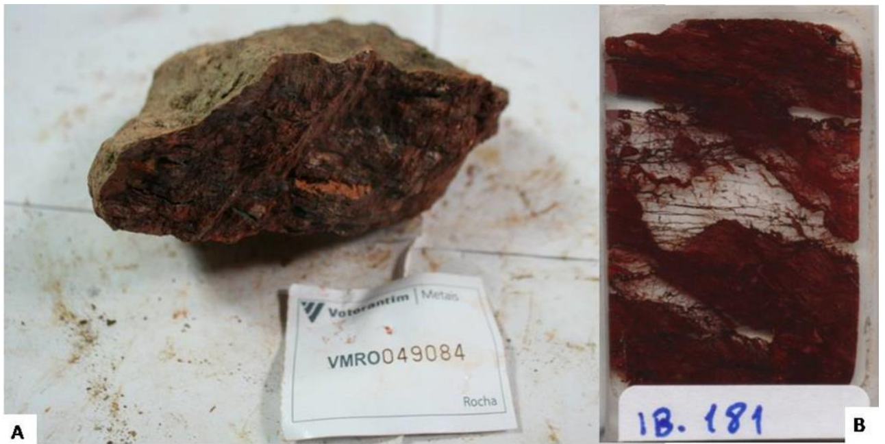
Figura 42. A - Foto da amostra de mão referente ao ponto geológico IB- 181. Notar duas estruturas planares: acamamento aproximadamente horizontal e foliação posterior, disposta do canto esquerdo inferior ao canto direito superior da amostra. B - Foto da seção delgada confeccionada a partir da mesma amostra.
