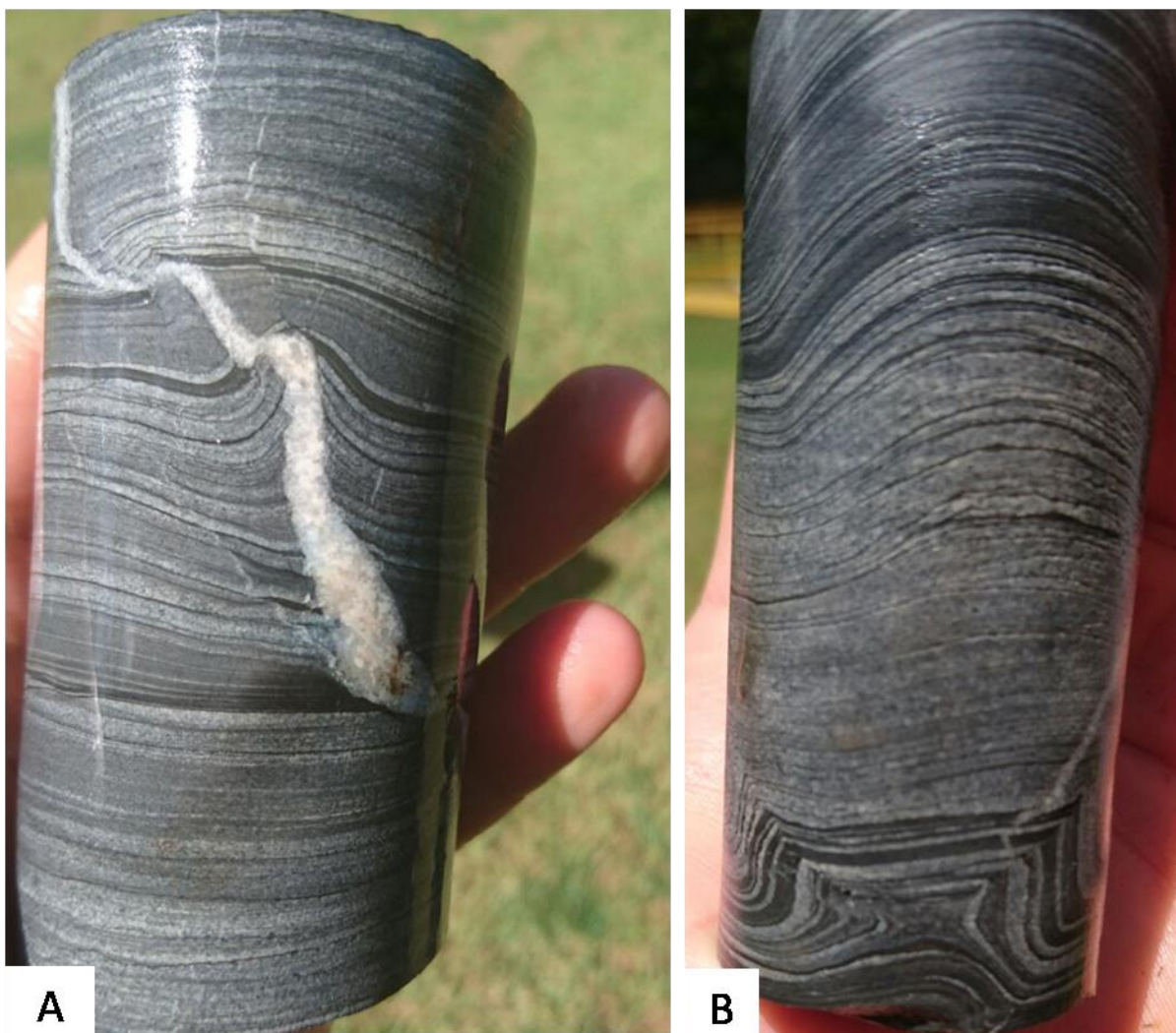
Figura 32. Amostras de testemunho de metamarga mostrando distintos padrões de dobramento e vênulas centimétricas de quartzo e dolomita branca arranjadas subparalelas ao plano axial.
