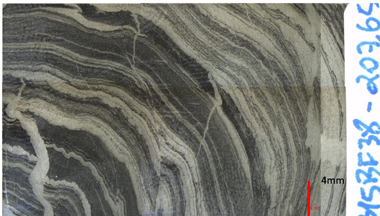
Figura 31. Metamarga representada por mosaico de fotos tiradas utilizando lupa. Notar deslocamento das vênulas e bandamento composicional, indicando cinemática de topo para o canto esquerdo superior da lâmina.
