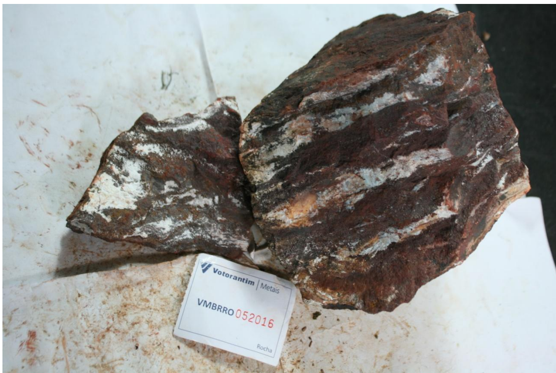
Figura 40. Amostra de mão de sílexito do contato de cavalgamento da Formação Lapa sobre a Formação Morro do Calcário. Notar bandamento tectônico marcado por ritmicidade entre bandas quartzosa e bandas de sulfetos oxidados.
