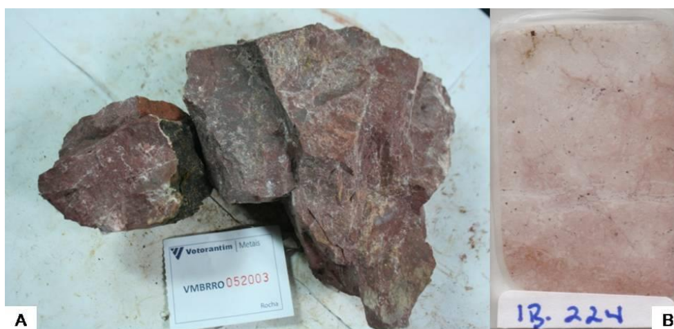
Figura 46: A - Amostra de dolomito cinza com porções hidrotermalizadas, com cor vermelha, devido à formação de carbonatos de ferro (ankerita e/ou siderita); B - Seção delgada da amostra IB 224.
