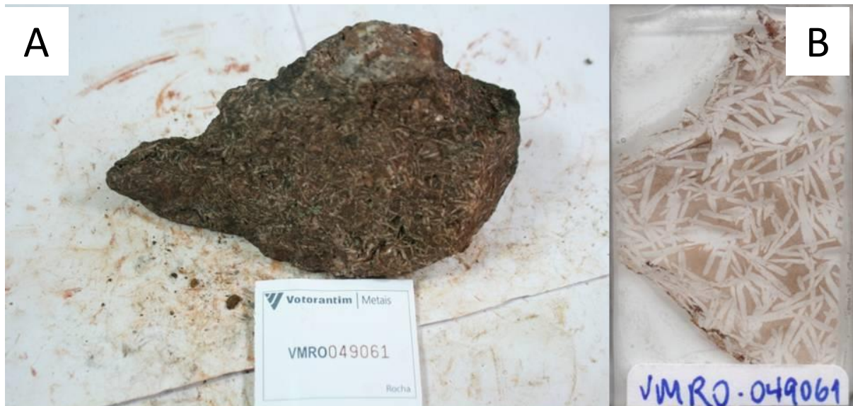
Figura 28: A – Amostra de mão; B – Foto da seção delgada, mostrando as acículas de quartzo.
